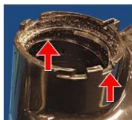
リテーナーの欠損 使用を中止してください
