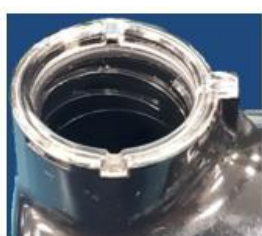
正常品(リテーナー) 使用可能です
